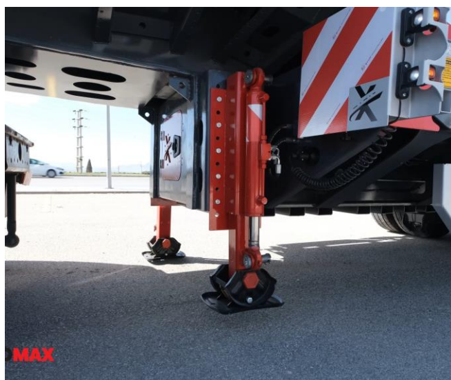
Hidraulinė atramų sistema
